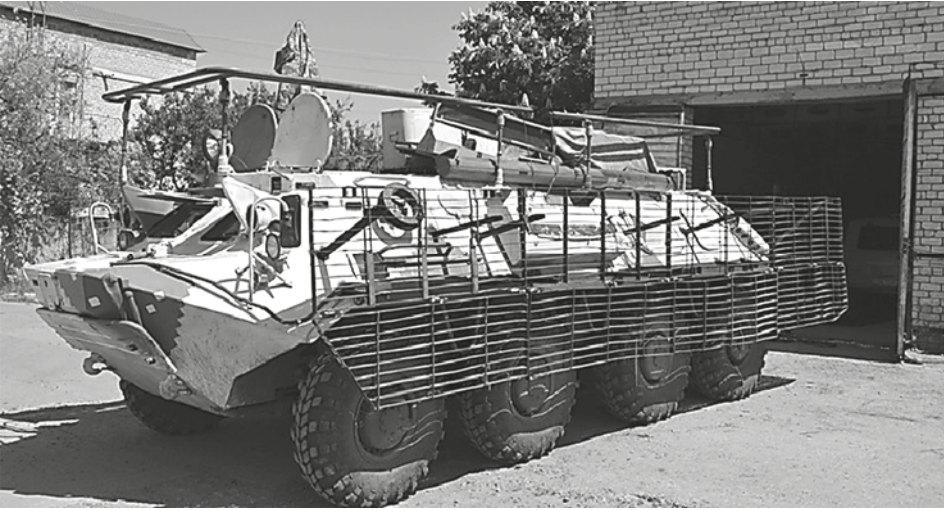
«Чайка» з кумулятивними решітками, відремонтована на автобазі морпорту
